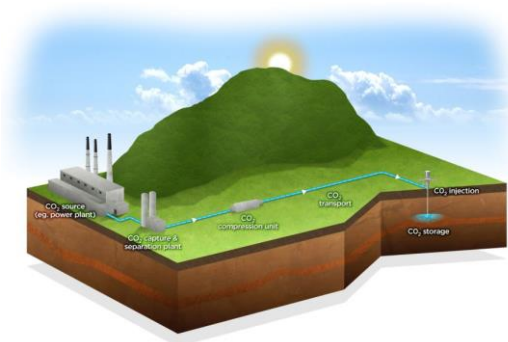
Figura 3. Representación gráfica del proceso de captura y almacenamiento de CO 2 . Fuente: Sustainability Today, Green City Times.
